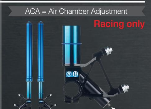
Diese patentierte Eigenentwicklung ermöglicht das Einstellen der Luftkammer mittels Sechskant.
